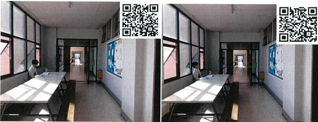
รูปที่ 4.9 ตัวส่งที่ระยะห่างจากตัวรับระยะ 30 เมตร และ 40 เมตรในตอนกลางวัน
