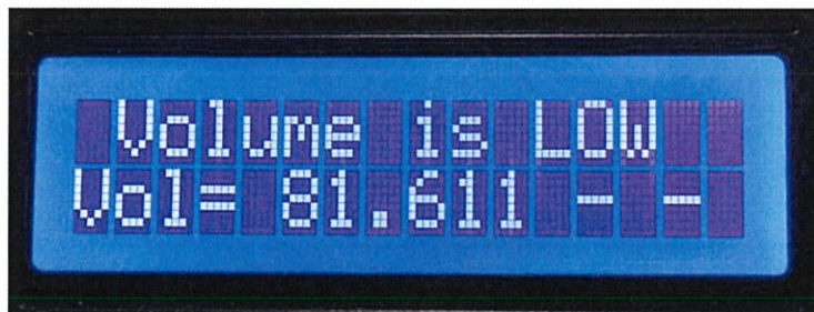
รูปที่ 4.16 หน้าจอแสดงผล(LCD) แสดงการแจ้งเตือนเมื่อปริมาตรของสารละลายต่ำกว่า 100 มล.
