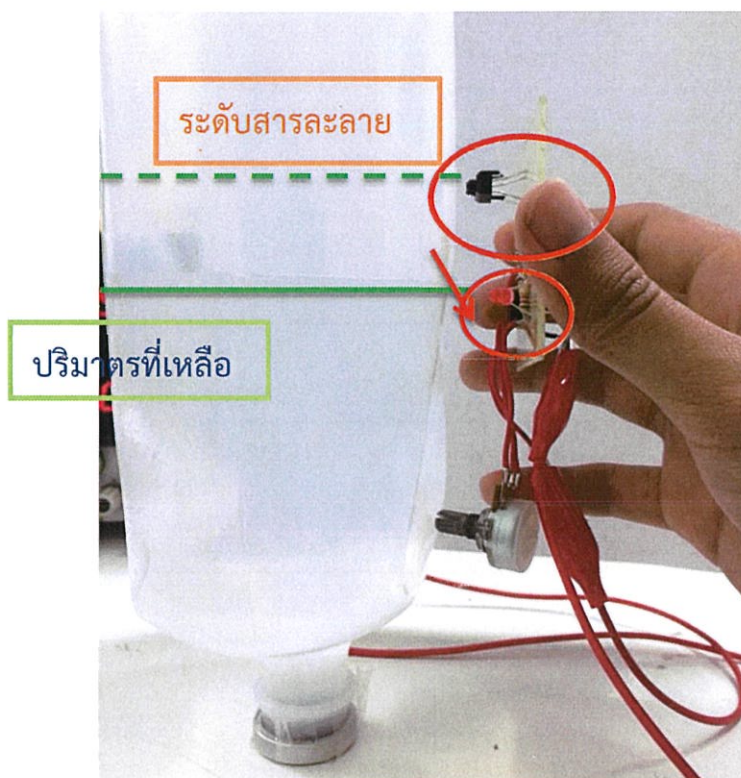
รูปที่ 3.12 ผลการทดลองวงจรวัดระดับปริมาตรสารละลายรุ่นที่ 3 เมื่อไม่มีสารละลาย
