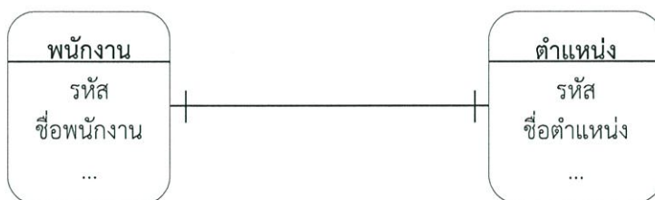
รูปที่ 2.5 แผนภาพแสดงความสัมพันธ์ระหว่างเอนทิตีแบบหนึ่งต่อหนึ่ง
