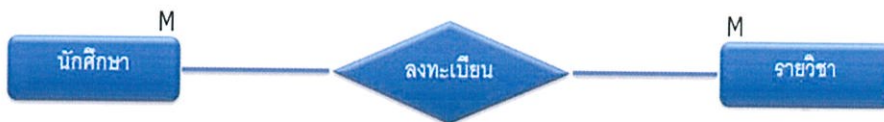
รูปที่ 2.4 แสดงความสัมพันธ์แบบกลุ่มต่อกลุ่ม
