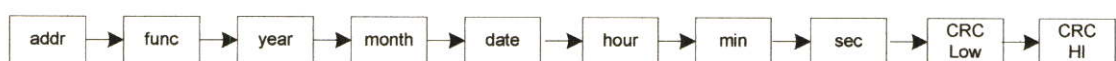
รูปที่ 4.7 บล็อกคำสั่งที่มีข้อมูล 6 ไบต์
