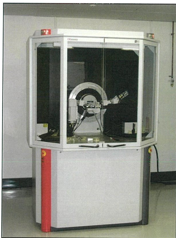
รูปที่ 3.1 ภาพถ่ายเครื่องเอกซเรย์ดิฟแฟรคโตมิเตอร์ ยี่ห้อ Bruker รุ่น D8 Advance
