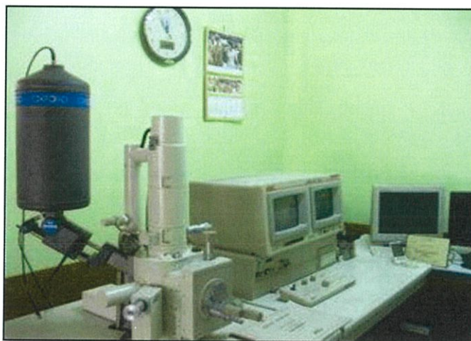
รูปที่ 3.2 ภาพถ่ายกล้องจุลทรรศน์อิเล็กตรอนแบบส่องกราดยี่ห้อ JEOL รุ่น JSM – 5410LV
