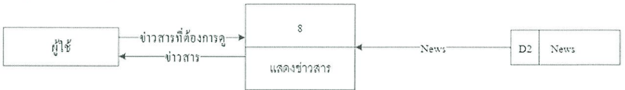
รูปที่ 3.12 Data Flow Diagram Level-1 การดูข่าวสารเศรษฐกิจ
