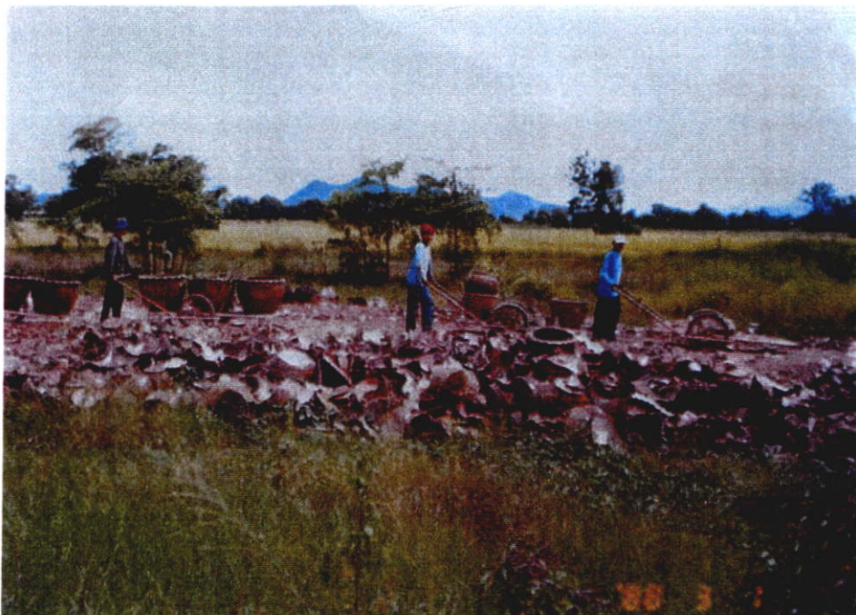
ภาพที่ 2.54 ผลิตรกษณ์เตาเสียหายจากการเผา ต้องนำไปทุบทำลายใช้ถักรมที่ต่อไป ที่มา : สมาคมเครื่องเคลือบดินเผาราชบุรี.
