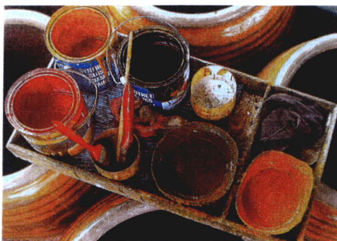
ภาพที่ 2.57 ผลิตภัณฑ์ที่มีตำหนิ หรือแตกเล็กน้อย ก็จะถูกนำไปซ่อมรอยร้าวซึม และทาสีให้เรียบร้อย ที่มา: สารคดีพิเศษ. (2540 : 221)
