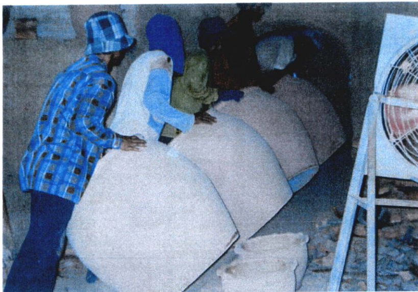
ภาพที่ 2.44 โถงที่เคลือบน้ำเคลือบแล้วกำลังถูกกล้าเรียงเข้าไปในเตา
