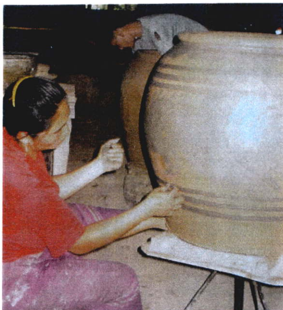
ภาพที่ 2.27 โอ่งมังกรที่เขียนลายโดยใช้ดินติดดอกเขียนลงบนแต่ละส่วนของโอ่ง ที่มา : โรงงานอุคมดินไทย . (ถ่ายเมื่อ : มีนาคม 2546)
