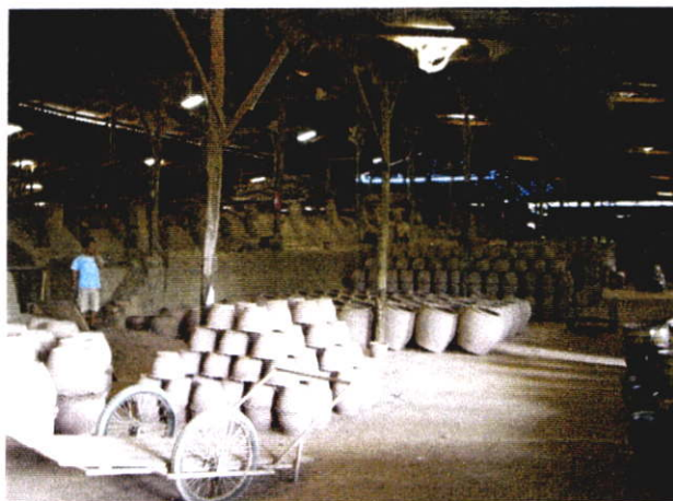
ภาพที่ 2.43 โอ่งและผลิตภัณฑ์อื่นที่ผ่านการเคลือบแล้ว จะถูกนำมาเรียงไว้ข้าง ๆ เพื่อรอการนำเข้าเตา ที่มา : โรงงานอุคมดินไทย. (ถ่ายเมื่อ : มีนาคม 2546)
