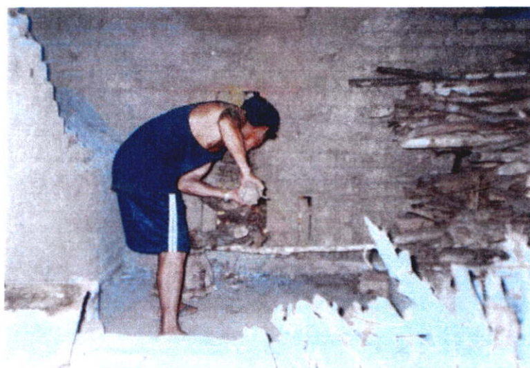
ภาพที่ 2.49 คนงานกำลังใส่ฟืนเพื่อเผาผลิตภัณฑ์ในเตาเผา ที่มา : สมาคมเครื่องเคลือบดินเผาราชบุรี.
