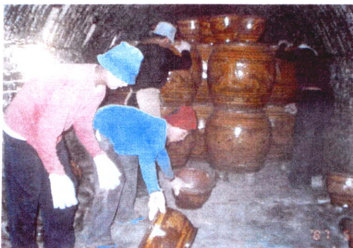
ภาพที่ 2.51 ผลิตภัณฑ์ภายในเตาเผา คนงานกำลังลำเลียงออกจากเตาเผา ที่มา : สมาคมเครื่องเคลือบดินเผาราชบุรี.
