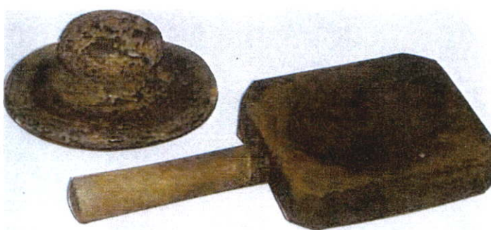
ภาพที่ 2.24 การแต่งผิวโอ่งให้เรียบและแต่งรูปทรงโดยใช้เครื่องมือที่เรียกว่า สวยหุบและไม้ตี
