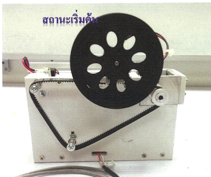
รูปที่ 3.10 สถานะเริ่มต้นของกระบวนการเริ่มทำงานให้กับเครื่องยนต์สเตอร์ลิง
