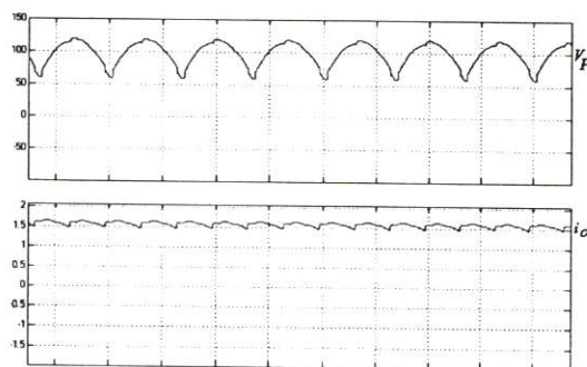
(ก) รูปสัญญาณ V_{pn}, i_o ที่ได้จากการจำลอง
