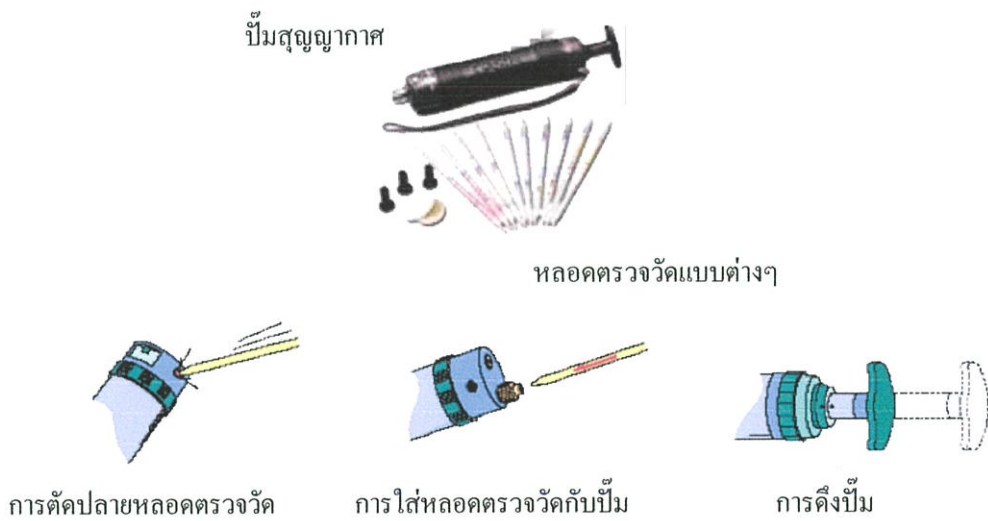
รูปที่ 2.18 อุปกรณ์และวิธีการใช้งานหลอดตรวจวัด [90]
