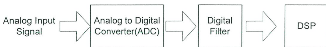
รูปที่ 3.5 ระบบประมวลผลสัญญาณดิจิทัล
