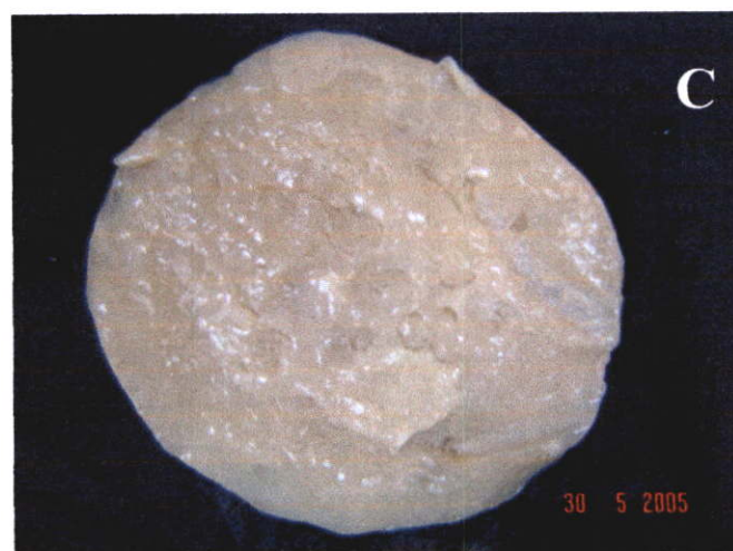
รูปที่ 4.5 แผ่นเซลล์โกลด์ที่ได้ในอาหารแต่ละสูตรร่วมกับเติมสารละลาย ไคโตซานความเข้มข้น 0.2 เปอร์เซ็นต์ (A) อาหารสูตรน้ำมะพร้าว (B) อาหารสูตรของ Hestrin and Schramm (C) อาหารสูตรของ Okiyama
