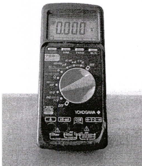
รูปที่ ก-5 Digital Multimeter ของบริษัท YOKOGAWA Model 73303
