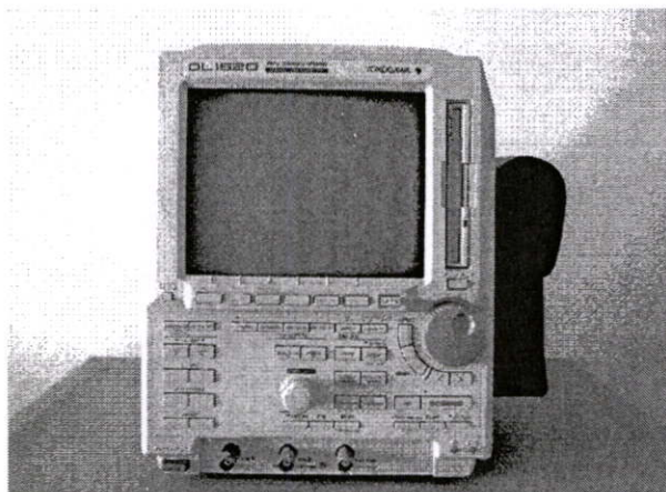
รูปที่ ก-1 Digital Oscilloscope 150 MHz ของบริษัท YOKOGAWA Model DL1520
