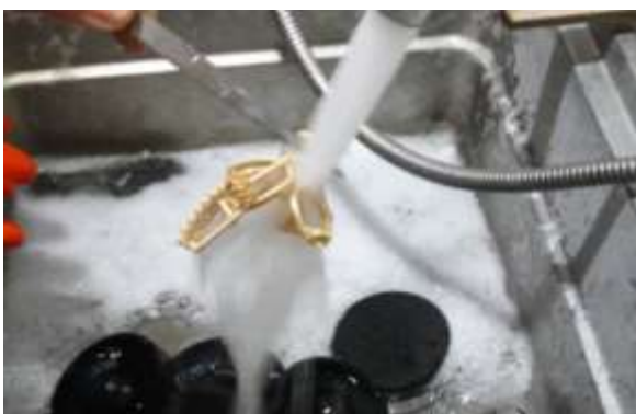
ภาพที่ 2.33 ภาพการทำความสะอาดชิ้นหล่อ
