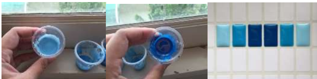
ภาพที่ ง.25 ลงยาสีเครื่องประดับ วางไว้รอให้น้ำยาแห้ง
