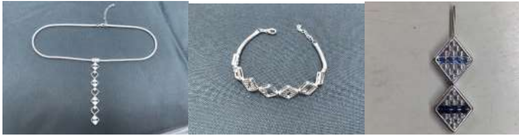
ภาพที่ ง.22 หล่อดัวเรือนออกมาเป็นเนื้อเงิน 925
