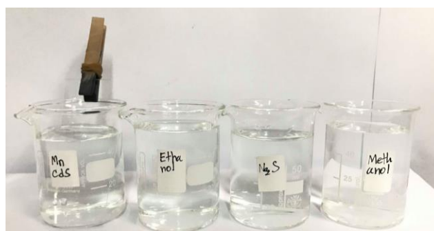
รูปที่ 3.8 การจุ่มแผ่นแก้วในสารละลายประจุบวก
