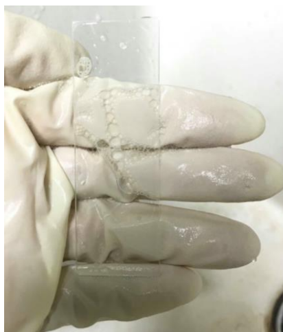
รูปที่ 3.4 ขั้นตอนการล้างแผ่นแก้วด้วยน้ำยาล้างจาน
