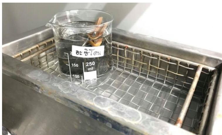
รูปที่ 3.5 ขั้นตอนการล้างแผ่นแก้วด้วยอะซิโตนในเครื่องอัลตราโซนิก
