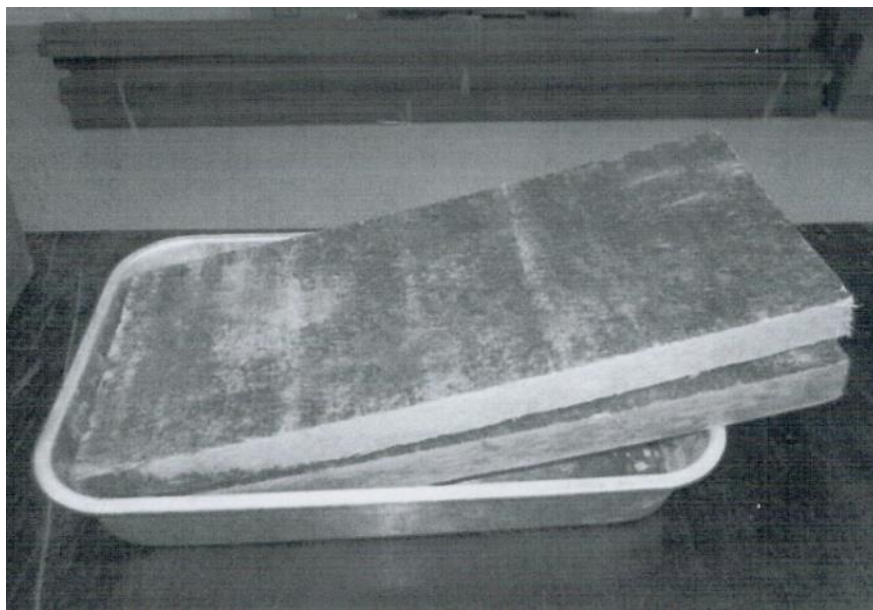
ภาพที่ จ.1 การทดสอบคุณสมบัติความชื้นของไม้ ตรวจสอบตามเกณฑ์ มาตรฐานอุตสาหกรรมวัสดุไม้ จากมหาวิทยาลัยเกษตรศาสตร์ วิทยาเขตบางเขน
