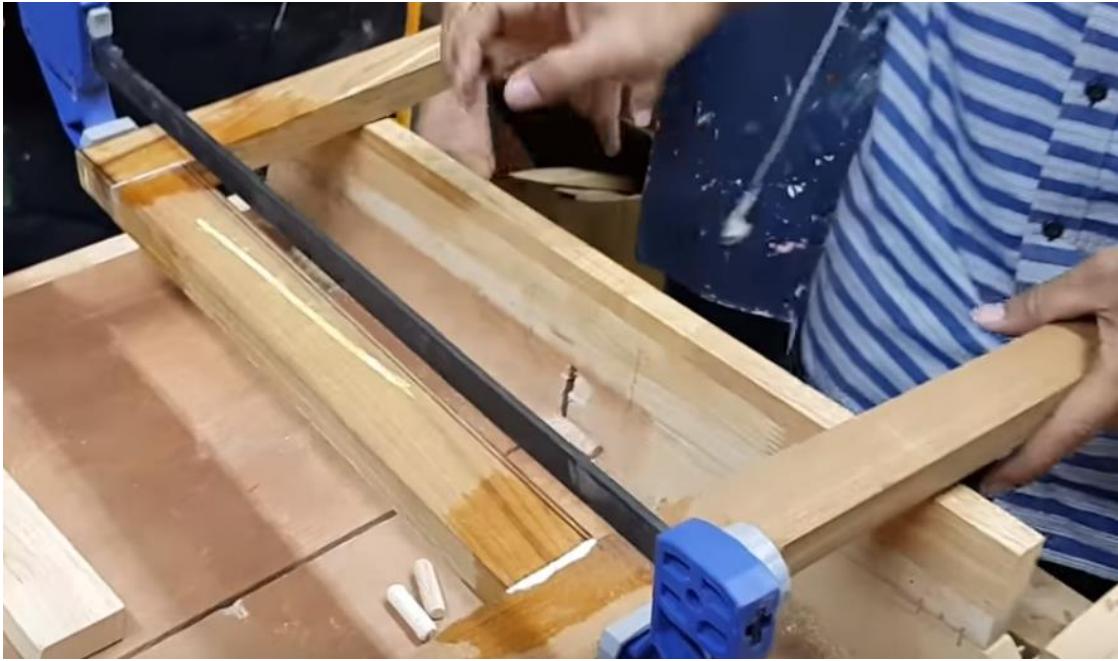
ภาพที่ จ.9 ขั้นตอนการทำเฟอร์นิเจอร์ ประกอบชิ้นส่วนของ ข้อต่อเฟอร์นิเจอร์
