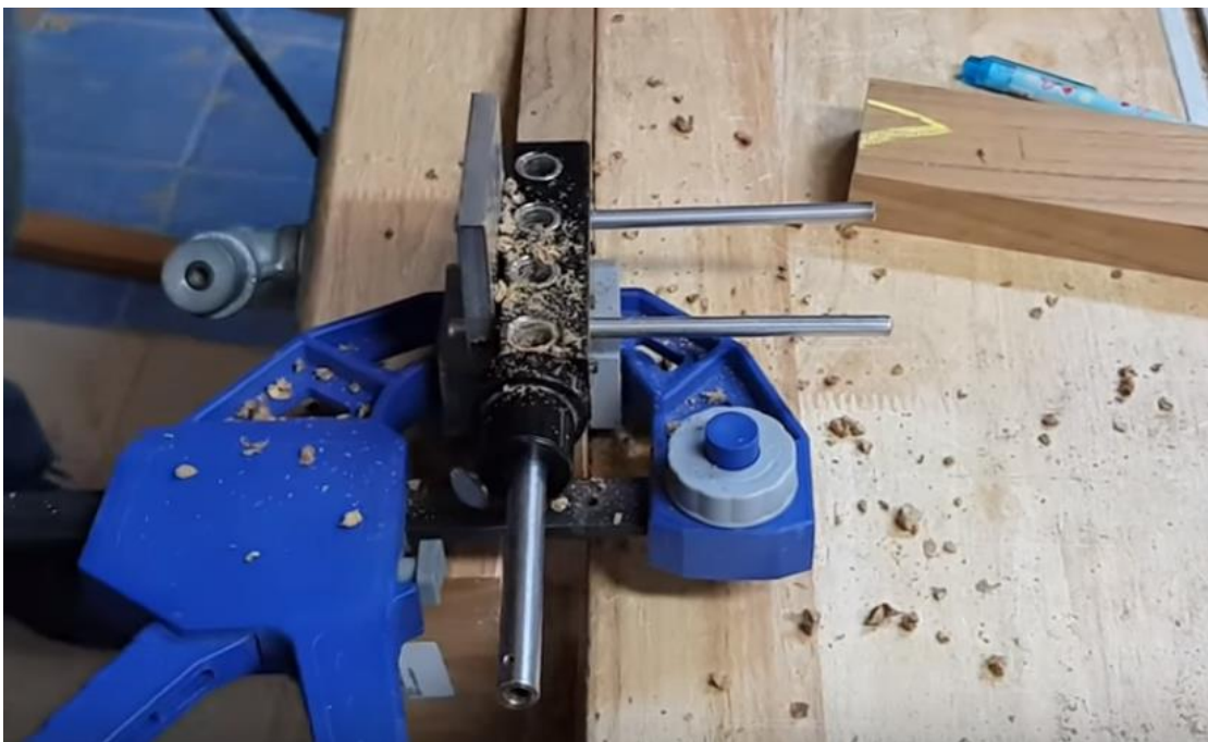
ภาพที่ จ.6 ขั้นตอนการทำเฟอร์นิเจอร์ ทำสัญลักษณ์เพื่อเจาะเต็ย ใช้จิ๊กซ์ช่วยจะให้ระยะเท่ากัน
