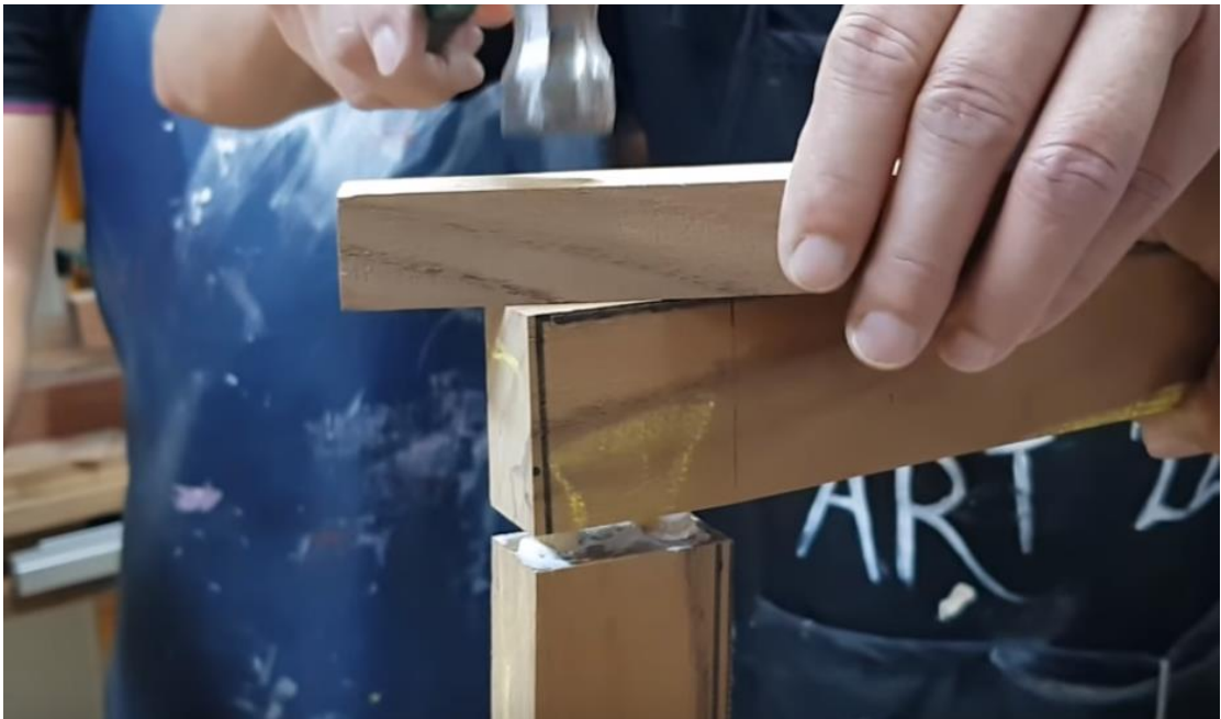
ภาพที่ จ.8 ขั้นตอนการทำเฟอร์นิเจอร์ ประกอบชิ้นส่วนของ ข้อต่อเฟอร์นิเจอร์
