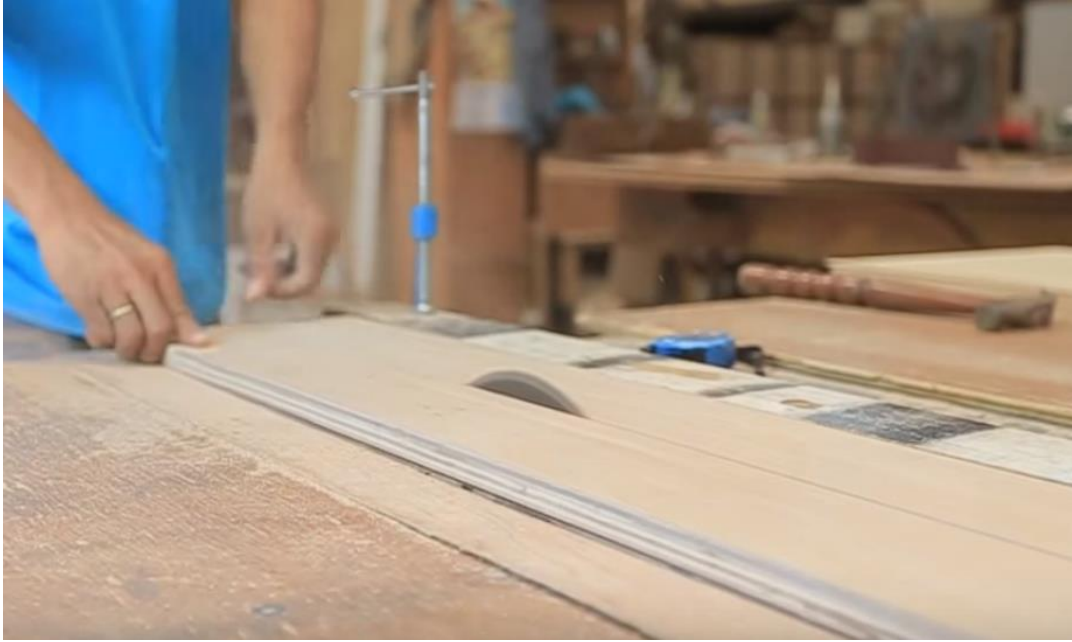
ภาพที่ จ.1 ขั้นตอนการทำเฟอร์นิเจอร์ เลื่อยไม้ให้ได้ตามขนาดเพื่อนำมาเป็นโครงสร้างเฟอร์นิเจอร์
