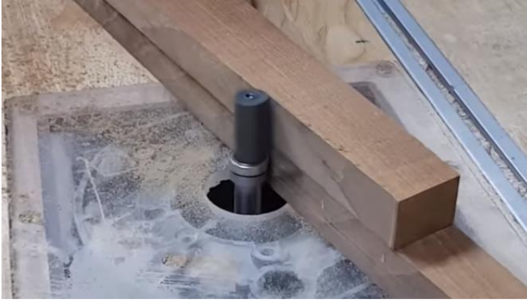
ภาพที่ จ.3 ขั้นตอนการทำเฟอร์นิเจอร์ ตัดขาหลังให้เท่ากันตามที่ได้ออกแบบเอาไว้
