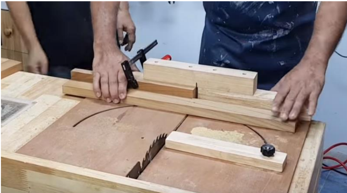
ภาพที่ จ.4 ขั้นตอนการทำเฟอร์นิเจอร์ ตัดขนาดสัดส่วนของผนังขา
