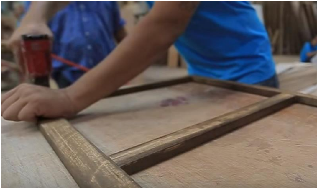
ภาพที่ จ.2 ขั้นตอนการทำเฟอร์นิเจอร์ นำไม้ขึ้นโครงสร้างตามขนาดเฟอร์นิเจอร์
