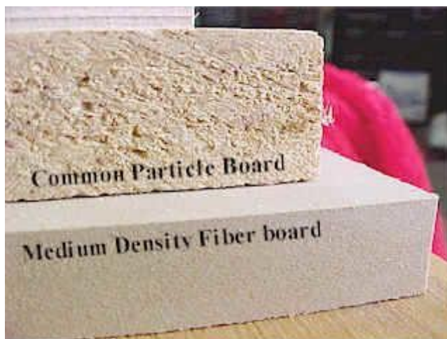
ภาพที่ 2.62 ความแตกต่างระหว่าง ปาร์ติเคิลบอร์ด กับ MDF ภาพโดย : สุนทร บินกาขานี (สืบค้น 13 ตุลาคม 2561)
