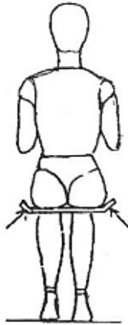
ภาพที่ 2.12 ที่นั่งสั้นเกินไปหรือยาวเกินไปจะทำให้เมื่อยขาด้านล่าง ที่มา : ออกแบบเฟอร์นิเจอร์ (กรุงเทพฯ: สมาคมส่งเสริมเทคโนโลยี (ไทย-ญี่ปุ่น) 2549)
