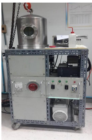
รูปที่ 3.1 อุปกรณ์ที่ใช้ในการเตรียมสิ่งประดิษฐ์ฟิล์มบางของสารกึ่งตัวนำ (\text{CdS})_{1-x}(\text{ZnTe})_x และฟิล์มบาง \text{CuSbS}_2 ที่เตรียมโดยวิธีการระเหยสารเคมีด้วยความร้อนในระบบสุญญากาศ
