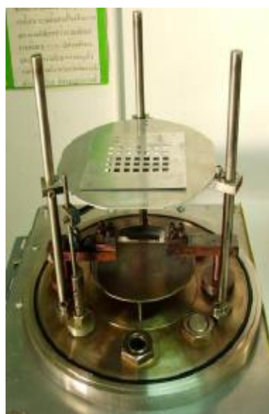
รูปที่ 3.1 อุปกรณ์ที่ใช้ในการเตรียมสิ่งประดิษฐ์ฟิล์มบางของสารกึ่งตัวนำ (\text{CdS})_{1-x}(\text{ZnTe})_x และฟิล์มบาง \text{CuSbS}_2 ที่เตรียมโดยวิธีการระเหยสารเคมีด้วยความร้อนในระบบสุญญากาศ
