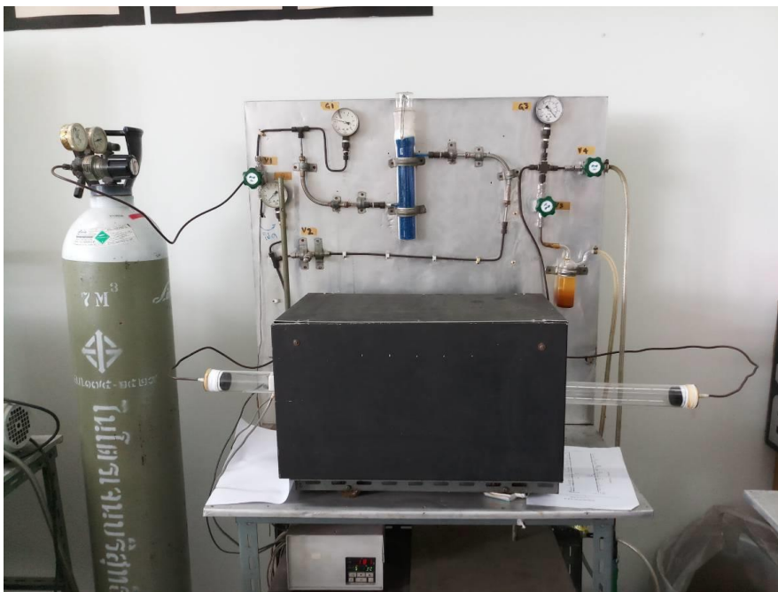
รูปที่ 3.2 อุปกรณ์ที่ใช้ในการเตรียมแอนนีสฟิล์มบางของสารกึ่งตัวนำ \text{CuSbS}_2 ที่เตรียมโดยวิธีการระเหยสารเคมีด้วยความร้อนในระบบสุญญากาศ
