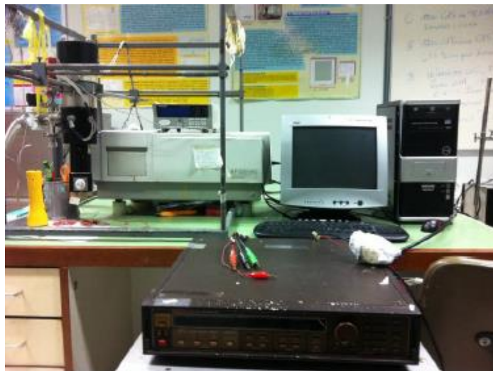
รูปที่ 3.3 อุปกรณ์ที่ใช้ในการศึกษาความสัมพันธ์ระหว่างค่ากระแสไฟฟ้า – แรงดันไฟฟ้า (I-V curve) ที่อุณหภูมิต่างๆ ของฟิล์มบางของสารกึ่งตัวนำ (\text{CdS})_{1-x}(\text{ZnTe})_x และฟิล์มบาง \text{CuSbS}_2 โดยวิธีการระเหยสารเคมีด้วยความร้อนในระบบสุญญากาศ
