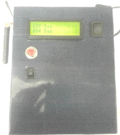
รูปที่ 4.5 แสดงค่าความดันโลหิตที่แสดงผ่านจอLCD
