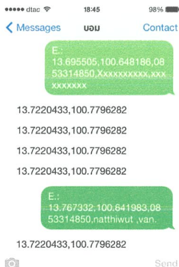
รูปที่ 4.25 แอปพลิเคชันส่งพิกัดที่อยู่ให้กับทางเซิร์ฟเวอร์ทุกๆ 30 วินาที
