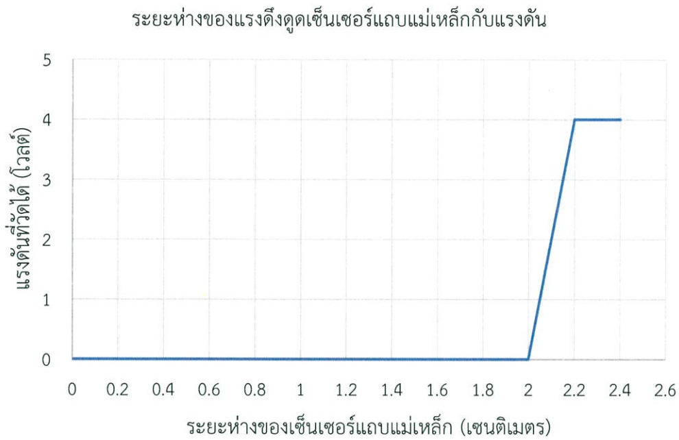
รูปที่ 4.4 ระยะห่างของแรงดึงดูดเซ็นเซอร์แถบแม่เหล็กกับแรงดัน
