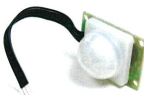
รูปที่ 2.18 โมดูลตรวจความเคลื่อนไหว KC7783R [4]
