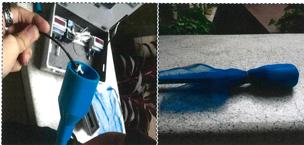
รูปที่ ข.2 รูปแสดงวิธีการป้องกัน Sensor จากความเสียหาย
