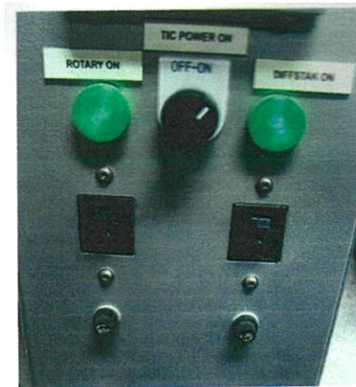
ภาพแสดงตำแหน่งสวิตช์ ROTARY ON (สำหรับเปิดปั๊มกลโรตารี) TIC POWER ON (สำหรับเปิดมาตรฐานวัดความดัน) และ DIFFSTAK ON (สำหรับเปิดปั๊มไอฟุ้งกระจาย)
