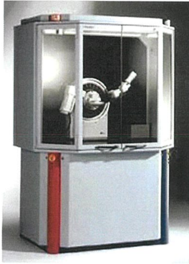
รูปที่ 3.1 ภาพถ่ายเครื่องเอกซ์เรย์ดิฟแฟรคโตมิเตอร์ ยี่ห้อ Bruker รุ่น D8 Advance
