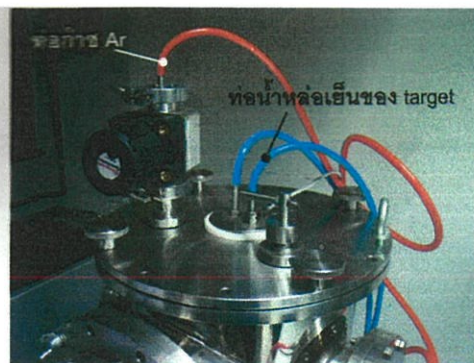
ภาพแสดงท่อก๊าซ Ar และท่อน้ำหล่อเย็นสำหรับ target
