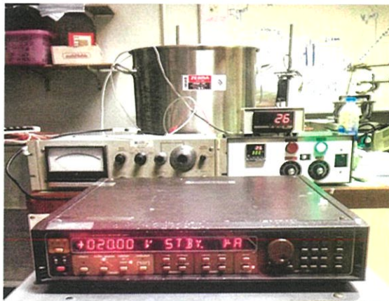
รูปที่ 3.6 ภาพถ่ายอุปกรณ์ที่ใช้ในการวัดความต้านทานของฟิล์มบางที่อุณหภูมิสูงกว่าอุณหภูมิห้อง
