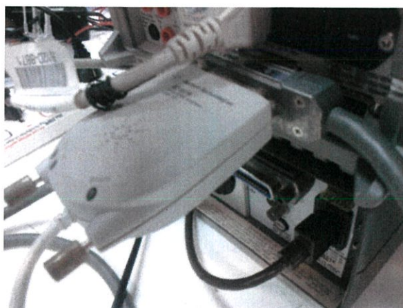
รูปที่ 23 การต่อสาย GPIB ระหว่างเครื่องมือวัดกับคอมพิวเตอร์
