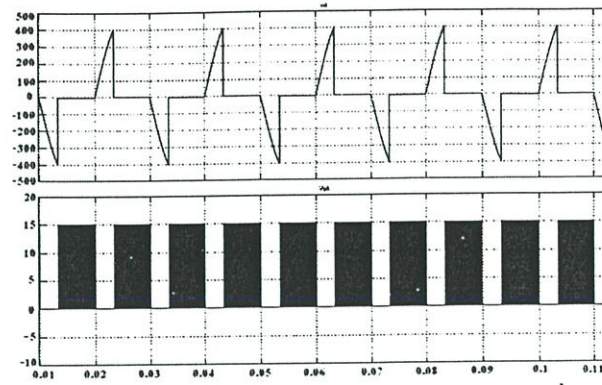
รูปที่ 4.9 บนแรงดันตกคร่อมเอสซีอาร์และล่างสัญญาณจุดชนวนที่ \alpha = 60 องศาโวลต์ R
