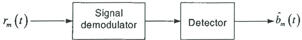
รูปที่ 2.5 โครงสร้างของวงจรภาครับสัญญาณ
