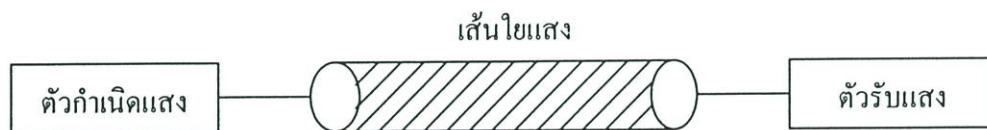
รูปที่ 2.3 องค์ประกอบพื้นฐานของระบบสื่อสารเส้นใยแสง
