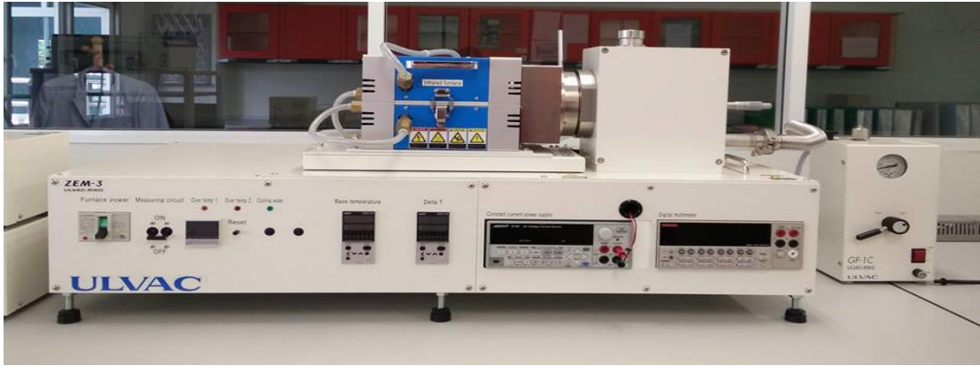
รูปที่ 2.19 แสดงเครื่องวัดค่าสภาพต้านทานไฟฟ้าและสัมประสิทธิ์ซีเบค หรือ ZEM-3
