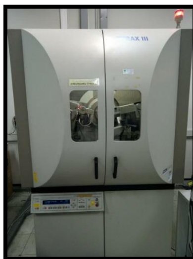
รูปที่ 3.5 เครื่องมือการวิเคราะห์การเลี้ยวเบนรังสีเอกซ์ (X-ray Diffractometer : XRD)
