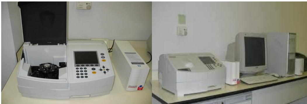
รูปที่ 3.3 ภาพถ่ายเครื่อง UV-VIS ยี่ห้อ Thermo electron corporation รุ่น ( \text{He } \lambda \text{ ios } \alpha )
