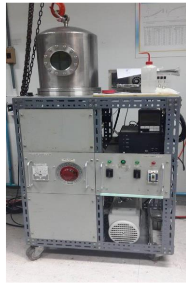
รูปที่ 3.9 อุปกรณ์ที่ใช้ในการเตรียมสิ่งประดิษฐ์ฟิล์มบางของสารกึ่งตัวนำ (\text{CdS}_x\text{Se}_{1-x})_{0.99}(\text{In}_2\text{S}_3)_{0.01} ที่เตรียมโดยวิธีการระเหิดสารเคมีด้วยความร้อนในระบบสุญญากาศ
