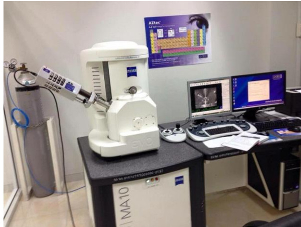
รูปที่ 3.2 ภาพถ่ายอุปกรณ์กล้องจุลทรรศน์อิเล็กตรอนแบบส่องกราด
