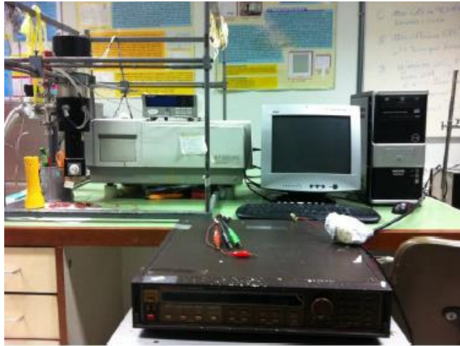
รูปที่ 3.10 อุปกรณ์ที่ใช้ในการศึกษาความสัมพันธ์ระหว่างค่ากระแสไฟฟ้า - แรงดันไฟฟ้า (I-V curve) ที่อุณหภูมิต่าง ๆ ของฟิล์มบางของสารกึ่งตัวนำ (\text{CdS}_x\text{Se}_{1-x})_{0.99}(\text{In}_2\text{S}_3)_{0.01} โดยวิธีการระเหยสารเคมีด้วยความร้อนในระบบสุญญากาศ
