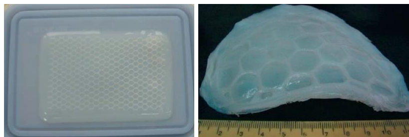
รูปที่ 2.11 เซลล์โลสจากแบคทีเรียในรูปของตาข่าย ที่มา: Gama et al. , (2013); Gama et al. , (2016)
