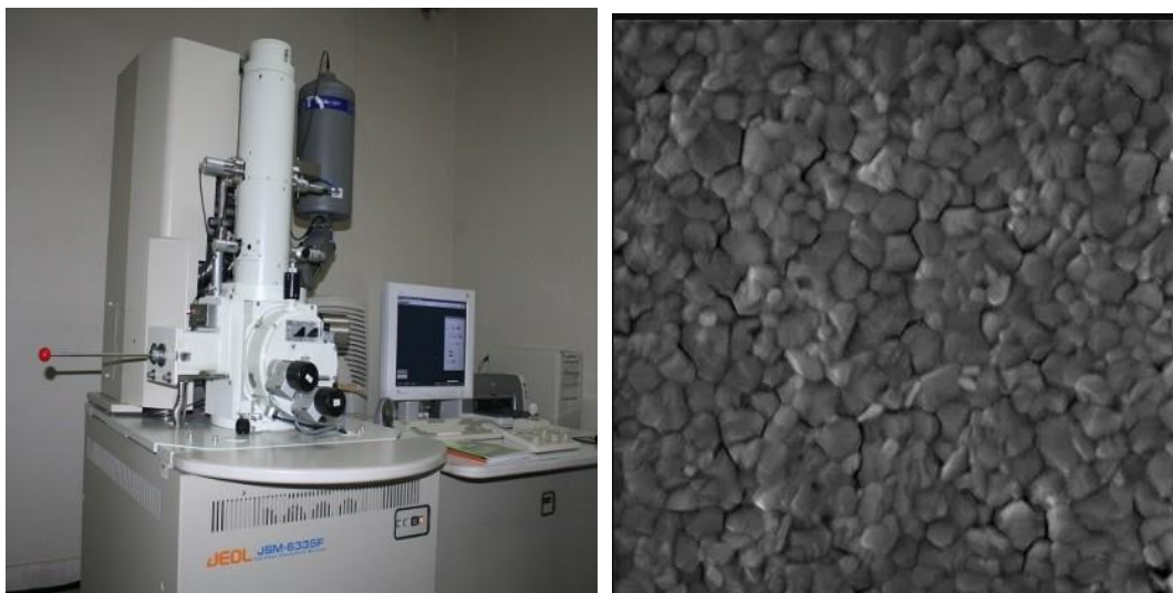
รูปที่ 3.18 กล้องจุลทรรศน์อิเล็กตรอนแบบส่องกราดชนิดฟิลด์อิมิส รุ่น JSM 6335 F และตัวอย่างรูปพื้นผิวฟิล์มบางเพอรอฟสไกต์
