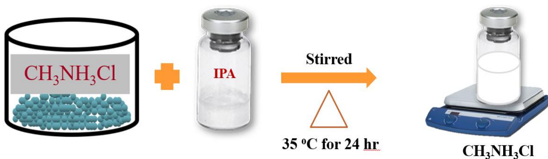
รูปที่ 3.7 แสดงขั้นตอนการเตรียมสารละลายสารละลายเมทิลแอมโมเนียมคลอไรด์
