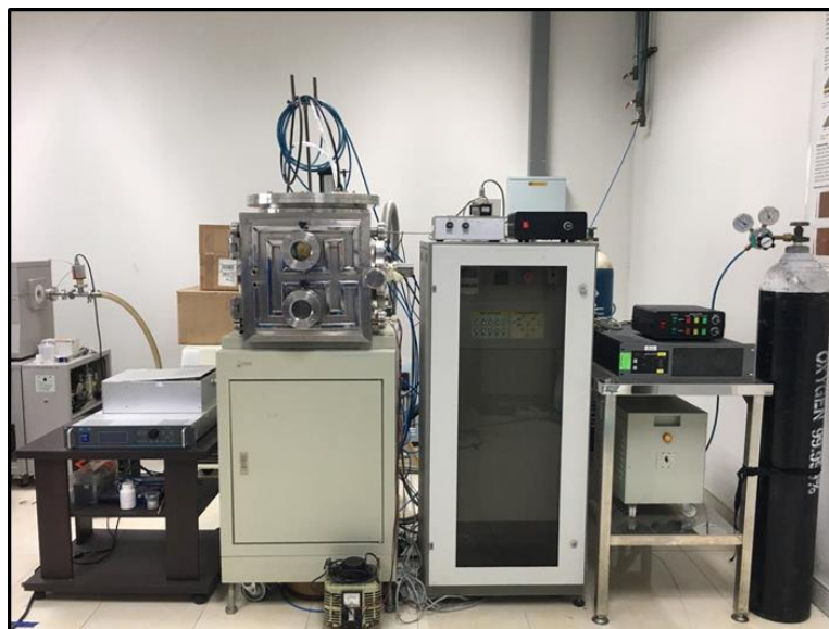
รูปที่ 3.3 เครื่องเคลือบฟิล์มบางอาร์เอฟแมกนีตรอนสเปตเตอริง
