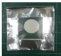
รูปที่ 3.2 ฟิล์มไฮโดรเจลห่อเม็ดยา ผนึกด้วยเทปกาวอคูมิเนียมทั้งสี่ด้าน
