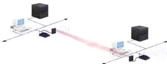
รูปที่ 2.11 การเชื่อมต่อของระบบเครือข่ายไร้สายแบบการใช้สายอากาศที่มีทิศทาง [35]
