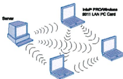
รูปที่ 2.7 การเชื่อมต่อของระบบเครือข่ายไร้สายแบบเพียร์ทูเพียร์ [35]
