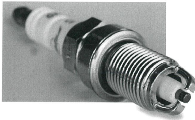
รูปที่ 2.33 หัวเทียนทองคำขาวแบบ 2 เขี้ยว
