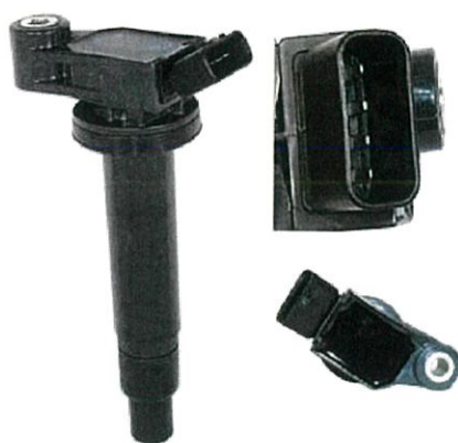
รูปที่ 2.25 คอยล์จุดระเบิดพร้อมกับวงจรขับเคลื่อนที่ติดตั้งภายใน
