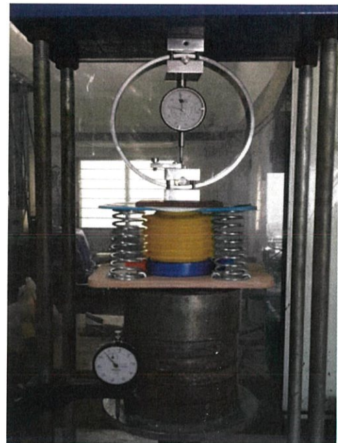
รูปที่ 3.2 ทดสอบหาค่าแรงของสปริง
