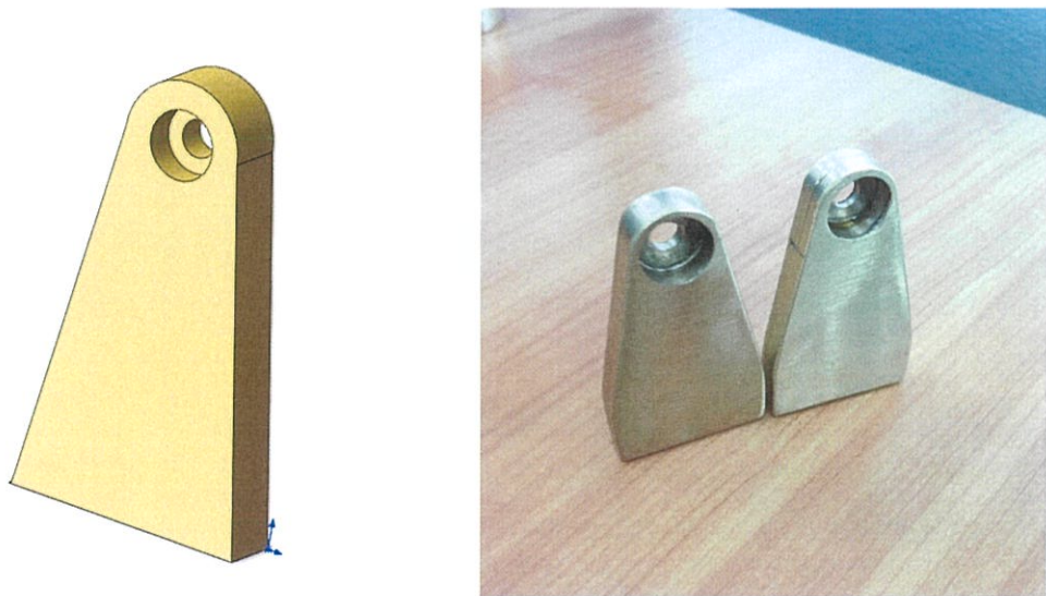
(2) รูปฐานยึดล้อเกียร์กระตุ้นใน solidwork 3D และชิ้นงานจริง
