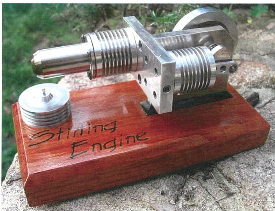
รูปที่ 2.5 เครื่องยนต์สเตอร์ลิงแบบเกมมาชนิดอุณหภูมิต่ำ
