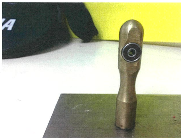
รูปที่ 3.11 ฐานเครื่องยนต์สเตอร์ลิง ชนิดแกมมา
