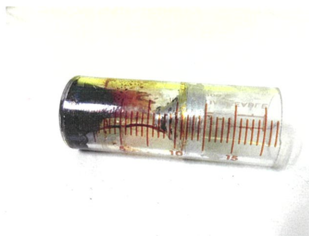
รูปที่ 3.3 หลอดแก้วด้านฮีทเตอร์ภายในครอบอกสูบคิสเพลสเซอร์
