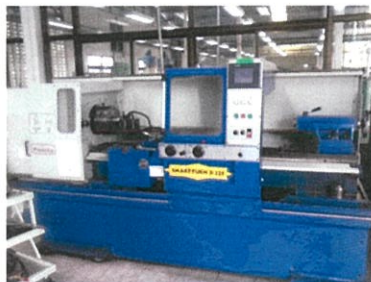
รูปที่ 3.27 เครื่องกลึงขั้นสูงชนิด NC และ CNC
