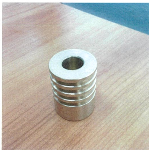
(2) รูปครอบอกสูบกำลังใน solidwork และ ชิ้นงานจริงที่กลึงขึ้น
