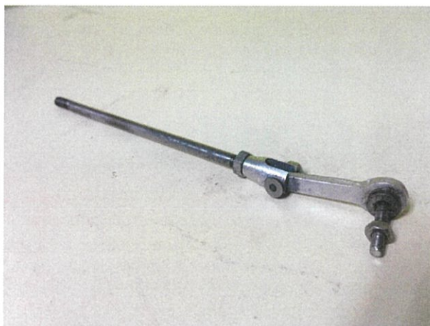
รูปที่ 3.5 ข้อเหวี่ยงที่ต่อกับก้านสูบคิสเพลสเซอร์
