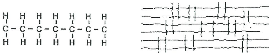
รูปที่ 5.2 โมเลกุลลูกโซ่พีอี และ โครงสร้างผลึกของเอ็กซ์แอลพีอี (XLPE)
