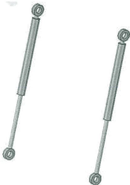
รูปที่ 3.7 การออกแบบส่วนรับแรงกระแทกด้วยโปรแกรม SPACECLAIM 2014
