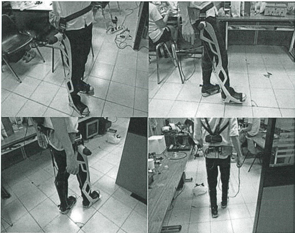
รูปที่ 4.15 ผู้ทดลองคนที่ 5 ทำการทดสอบเครื่องช่วยพยุงร่างกายส่วนล่าง
