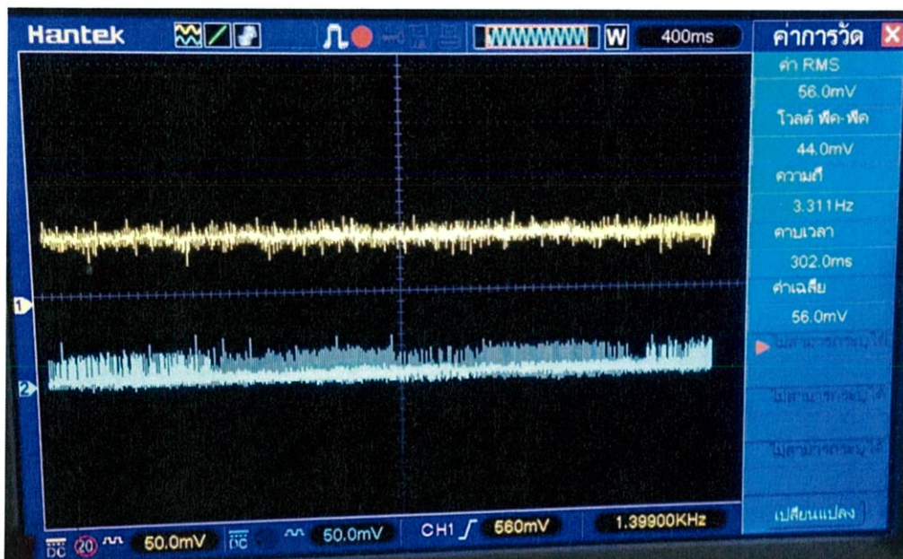
รูปที่ 4.6 สัญญาณไฟฟ้าขาออกเมื่อวางแขนไว้บนโต๊ะ
