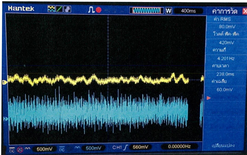
รูปที่ 4.5 สัญญาณไฟฟ้าขาออกเมื่อเย็นขึ้นแล้วปล่อยแขนตามแนวดิ่ง
