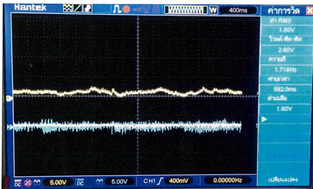
รูปที่ 4.7 สัญญาณไฟฟ้าขาออกเมื่อขยับแขนขึ้นลง 3 ครั้งโดยไม่เกร็ง
