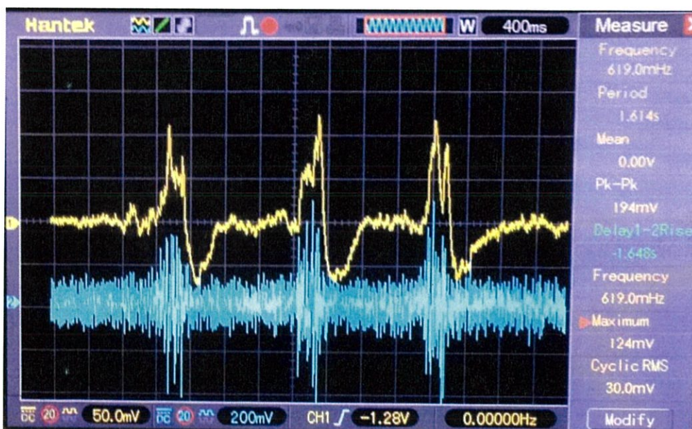
รูปที่ 4.4 สัญญาณไฟฟ้าขาออกเมื่อผ่านและยังไม่ผ่านวงจรกรองความถี่และวงจรเรียงกระแส
