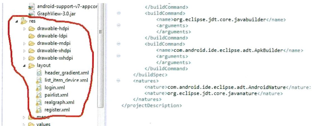
รูปที่ 3.72 แสดงตำแหน่งของ Layout ( res > layout > layout name.xml)
