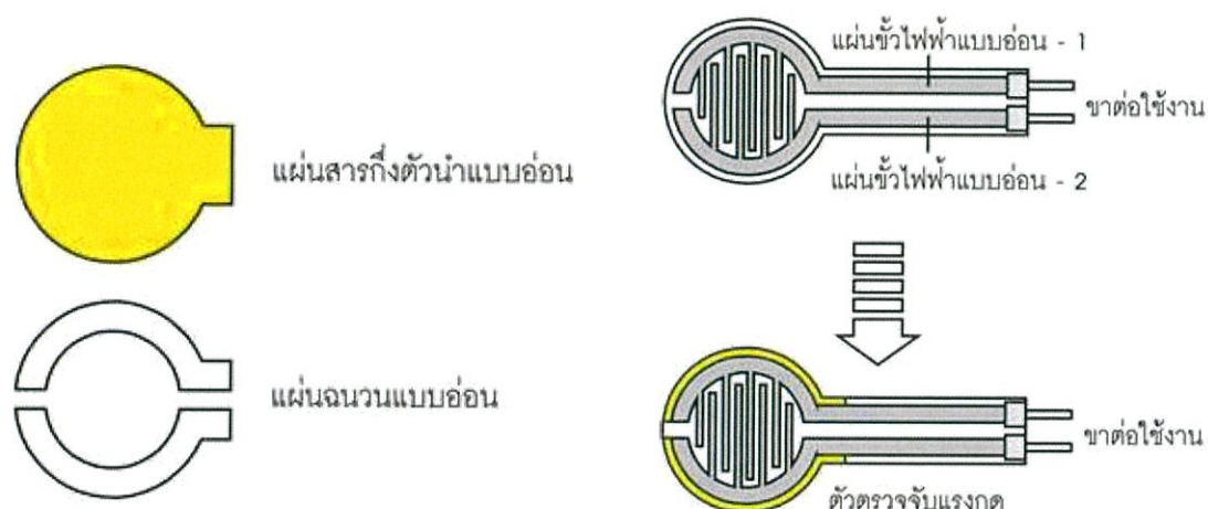
รูปที่ 2.13 ลักษณะโครงสร้างของตัวตรวจจับแรงกด FSR
