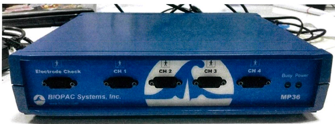
รูปที่ 4.17 MP36 data acquisition unit
