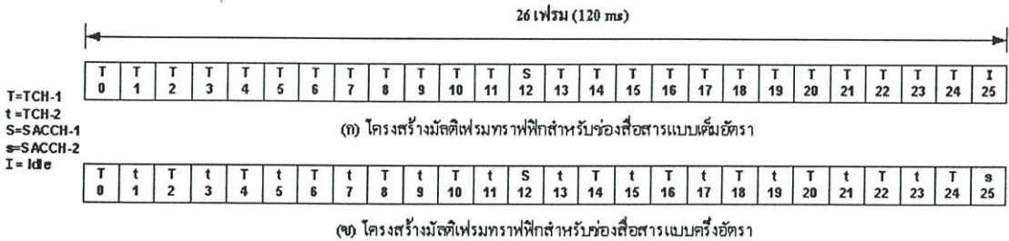
รูปที่ 2.15 โครงสร้างของมัลติเฟรมช่องสื่อสารข้อมูล
