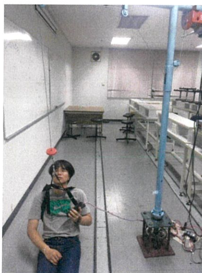
รูปที่ 4.5 การทดลองใช้เครื่องช่วยลุกสำหรับผู้ป่วยกล้ามเนื้ออ่อนแรงกับคนจริง
