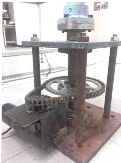
รูปที่ 4.2 การทดลองการหมุนและปรับความเร็วของมอเตอร์ที่ใช้สำหรับหมุนเสา
