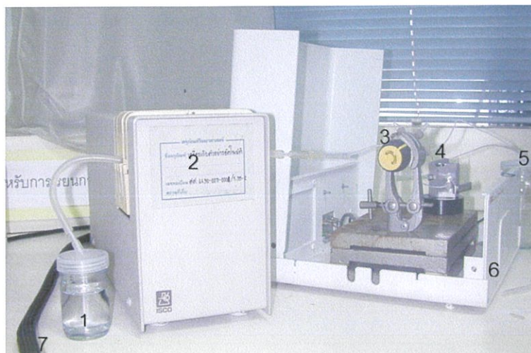
รูปที่ 3.6 การจัดเครื่องมือในระบบการไหลต่อเนื่อง
