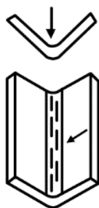
ภาพที่ 2.24 การย่นและแตกของมุมโค้งด้านในของรอยพับแผ่นพอลิเมทิลเมทาคริเลต ที่มา : อนุวัต สุเพียร. 2544
