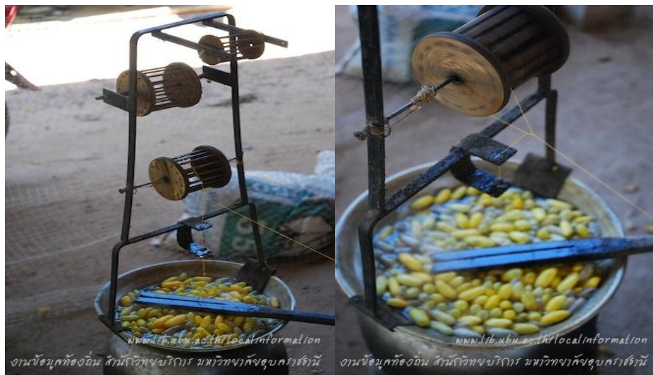
ภาพที่ 2.11 ติดตั้งหม้อต้มรังไหมกับพวงสาว
