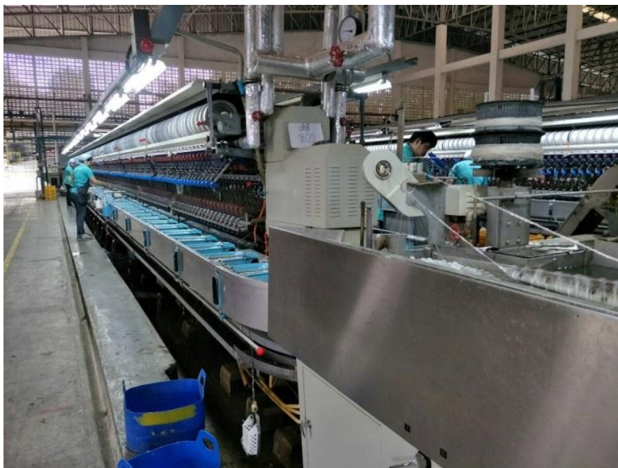
ภาพที่ ง.17 เครื่องสำหรับแยกเส้นใยเปลือกนอกรังไหม
