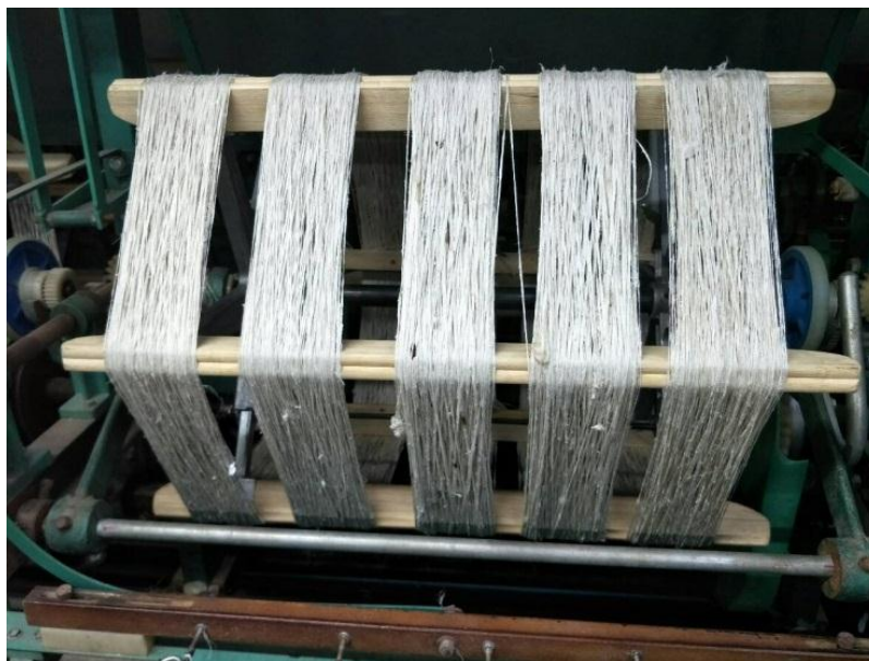
ภาพที่ ง.21 เส้นไหมดิบที่ยังไม่ผ่านการลอกกา
