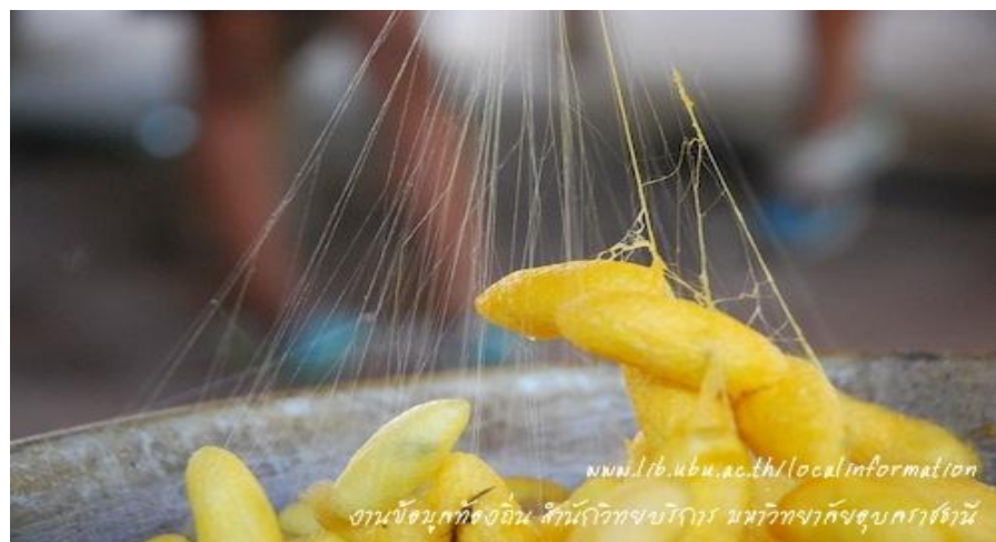
ภาพที่ 2.12 เส้นใยหลายเส้น สาวขึ้นแล้วตีเกลียวให้แน่นเป็นเส้นเดียว
