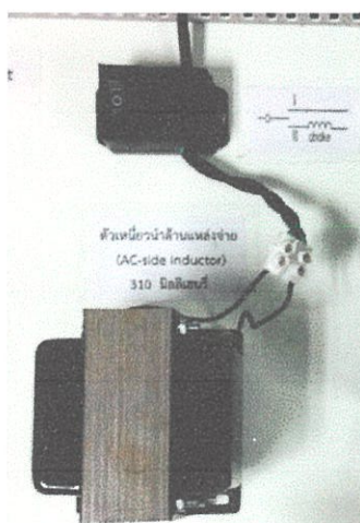
รูปที่ 5.3 ส่วนของตัวเหนี่ยวนำด้านแหล่งจ่าย ขนาด 0.310 เฮนรี
