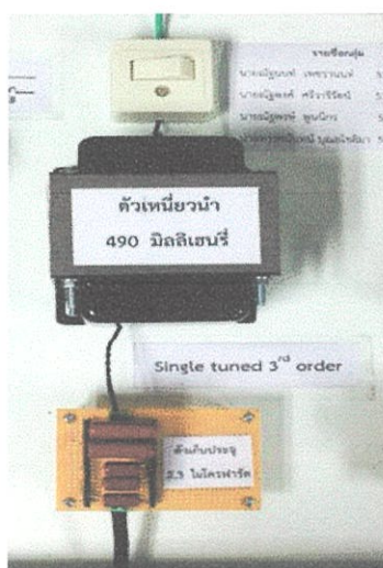
รูปที่ 5.7 ส่วนของวงจรกรองฮาร์มอนิกแบบจูนเฉพาะความถี่ลำดับที่ 3
