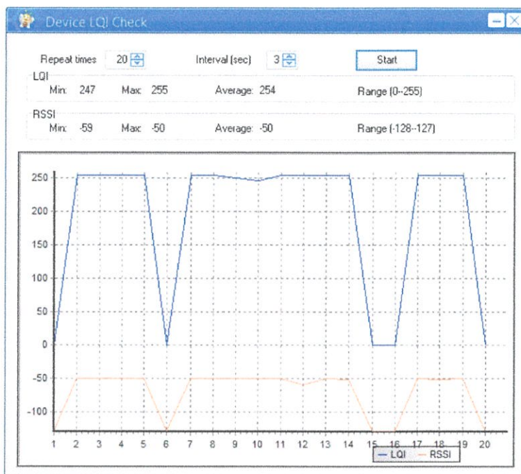
รูปที่ 4.27 ผลการทดสอบการวัดสัญญาณซิกบี (Zigbee) ในระยะตั้งแต่ 25 เมตรถึง 75 เมตร
