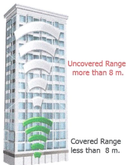
รูปที่ 4.33 สรุปผลการทดสอบการวัดสัญญาณซิกบี (Zigbee) ในแนวตั้งโดยสี่เหลี่ยมจะเป็นระยะที่อุปกรณ์ทำงานได้ ส่วนสีแดงจะเป็นระยะที่อุปกรณ์ไม่สามารถทำงานได้
