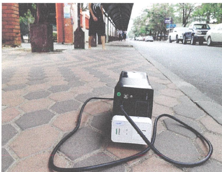
รูปที่ 4.19 ปลั๊กที่มีการสื่อสารแบบซิกบี (Zigbee) โดยใช้ UPS เป็นแหล่งจ่ายชั่วคราว
