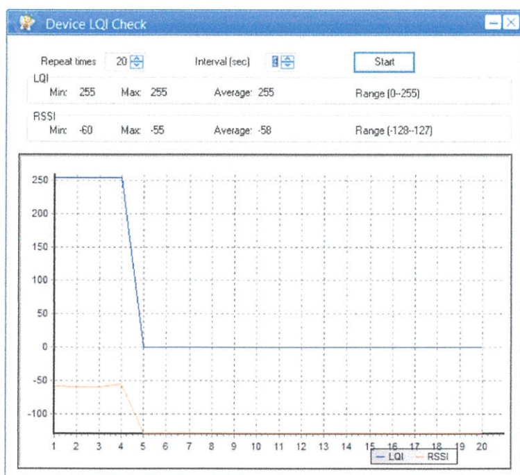
รูปที่ 4.28 ผลการทดสอบการวัดสัญญาณซิกบี (Zigbee) ที่ระยะทางมากกว่า 75 เมตร
