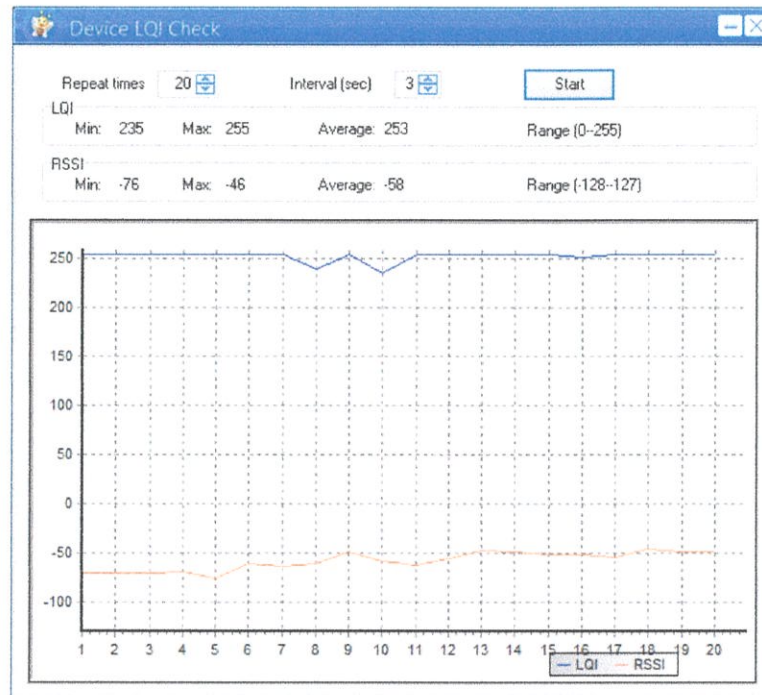
รูปที่ 4.26 ผลการทดสอบการวัดสัญญาณซิกบี (Zigbee) ในระยะตั้งแต่ 5 เมตรถึง 20 เมตร
