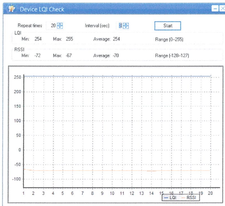
รูปที่ 4.32 ผลการทดสอบการวัดสัญญาณซิกบี (Zigbee) เมื่อมีวัสดุกีดขวางที่ระยะ มากกว่า 8 เมตร ในแนวตั้ง
