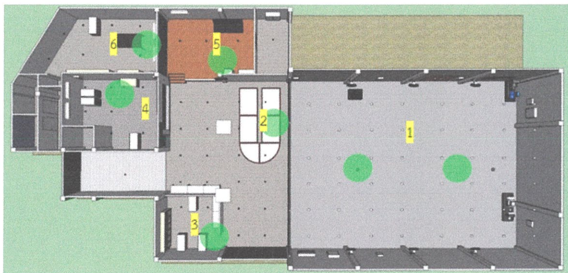
รูปที่ 4.1 Floor plan และตำแหน่งการติดตั้งของเซนเซอร์
