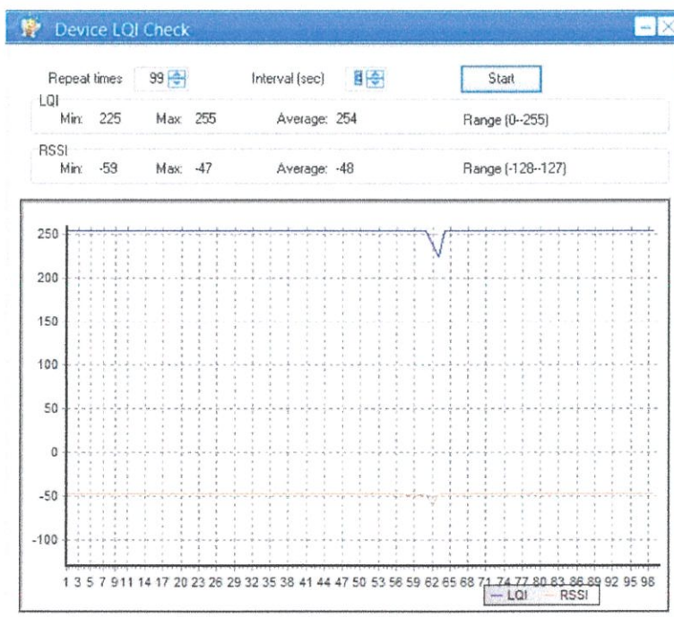
รูปที่ 4.21 ผลการทดสอบการวัดสัญญาณซิกบี (Zigbee) ในระยะตั้งแต่ 5 เมตรถึง 40 เมตร
