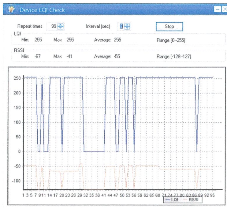
รูปที่ 4.23 ผลการทดสอบการวัดสัญญาณซิกบี (Zigbee) ในระยะตั้งแต่ 95 เมตรถึง 150 เมตร
