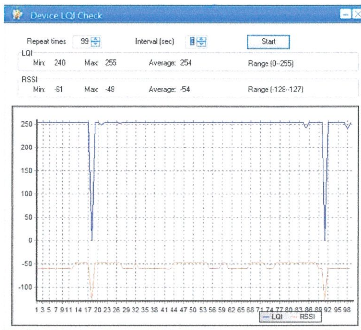
รูปที่ 4.21 ผลการทดสอบการวัดสัญญาณซิกบี (Zigbee) ในระยะตั้งแต่ 5 เมตรถึง 40 เมตร
