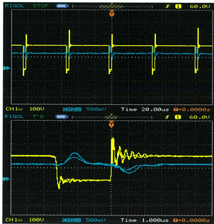
รูปที่ 4.13 รูปคลื่นแรงดันและกระแสที่ความเร็วลม 12m/s ที่กำลังสูงสุด (เส้นสีเหลือง) แรงดัน 100V/Div (เส้นสีฟ้า) กระแส 5A/Div (บน) Time/Div = 20 us (ล่าง) Time/Div = 1 us
