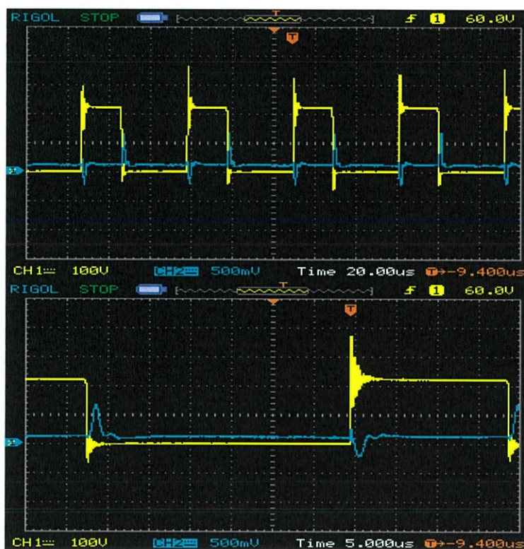
รูปที่ 4.34 รูปคลื่นแรงดันและกระแสที่ความเร็วลม 5m/s ที่กำลังสูงสุด (เส้นสีเหลือง) แรงดัน 100V/Div (เส้นสีฟ้า) กระแส 5A/Div (บน) Time/Div = 20 us (ล่าง) Time/Div = 5 us
