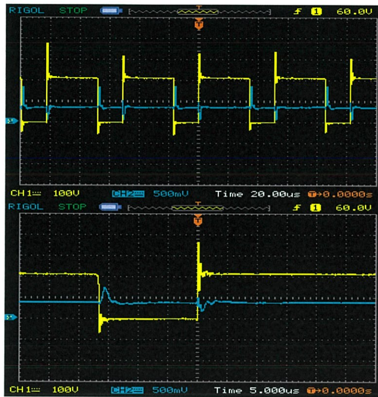
รูปที่ 4.22 รูปคลื่นแรงดันและกระแสที่ความเร็วลม 9m/s ที่กำลังสูงสุด (เส้นสีเหลือง) แรงดัน 100V/Div (เส้นสีฟ้า) กระแส 5A/Div (บน) Time/Div = 20 us (ล่าง) Time/Div = 5 us
