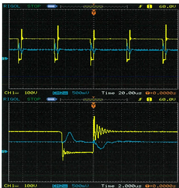
รูปที่ 4.16 รูปคลื่นแรงดันและกระแสที่ความเร็วลม 11m/s ที่กำลังสูงสุด (เส้นสีเหลือง) แรงดัน 100V/Div (เส้นสีฟ้า) กระแส 5A/Div (บน) Time/Div = 20 us (ล่าง) Time/Div = 2 us
