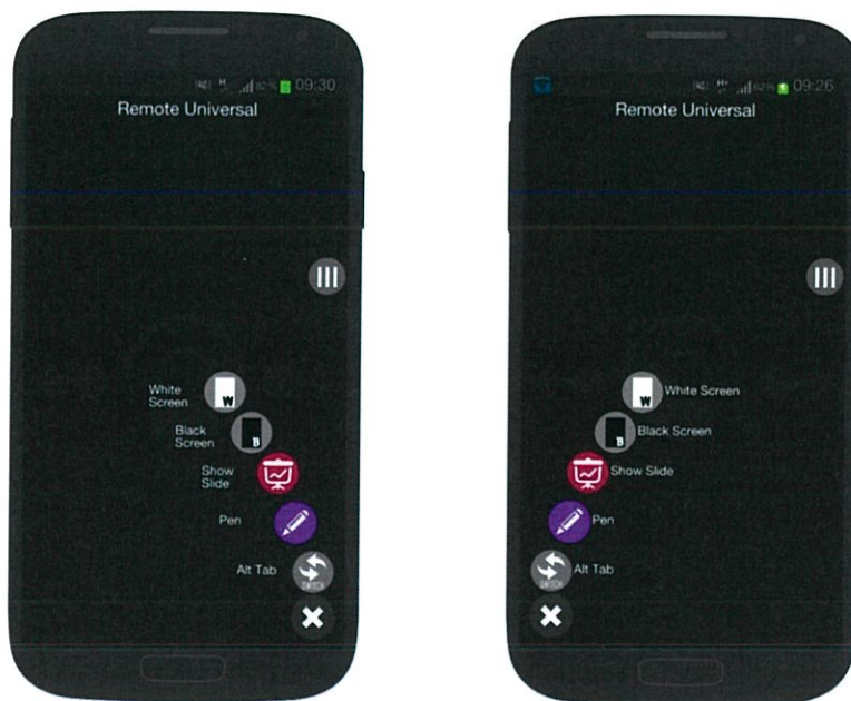
รูปที่ 4.6 ตัวอย่างการจัดเรียงไอคอนสำหรับผู้ใช้นัดมือซ้าย (ภาพ ซ้าย) และนัดมือขวา (ภาพขวา)
