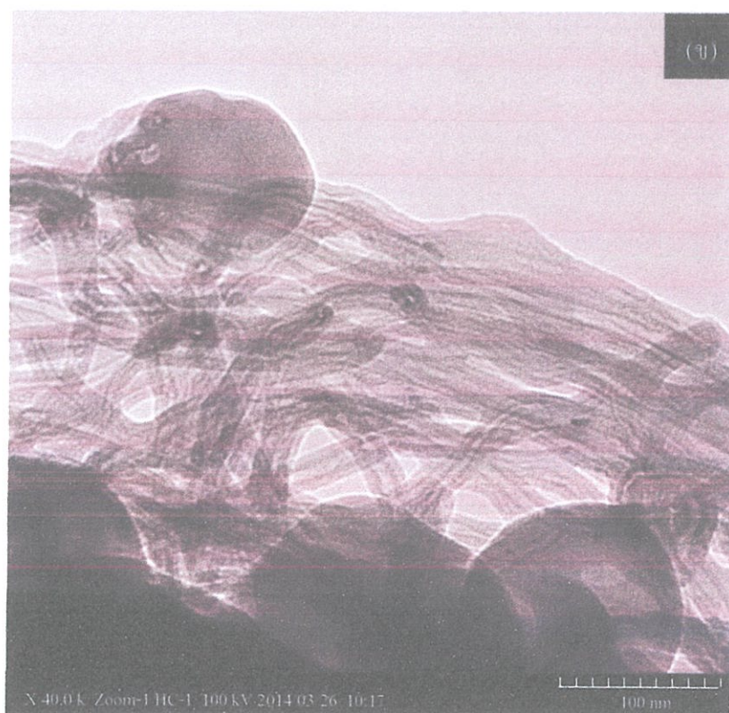
รูปที่ 4.9 ภาพถ่าย TEM ของ CNTs ที่กำลังขยาย 25,000 เท่า (ก) และ 40,000 เท่า (ข)
